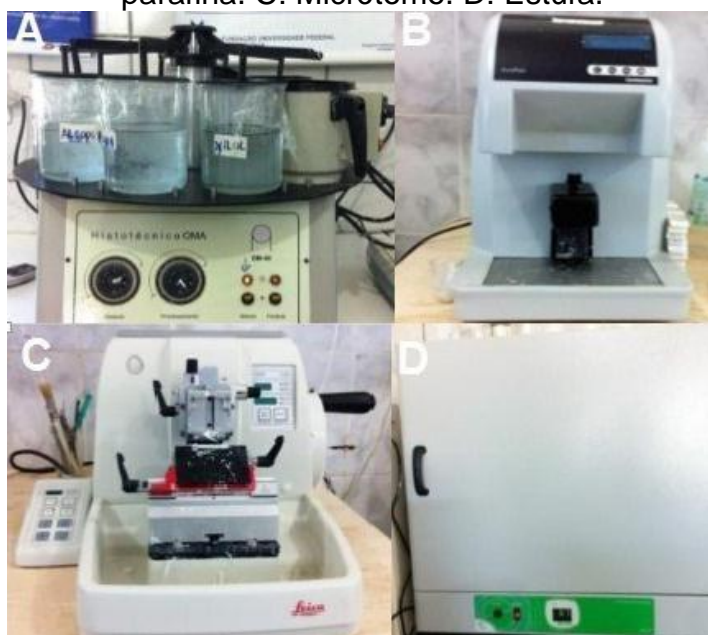
Figura 9: Equipamento histotécnico. A: Histotécnico OMA. B: Dispensador de parafina. C: Micrótomo. D: Estufa.
